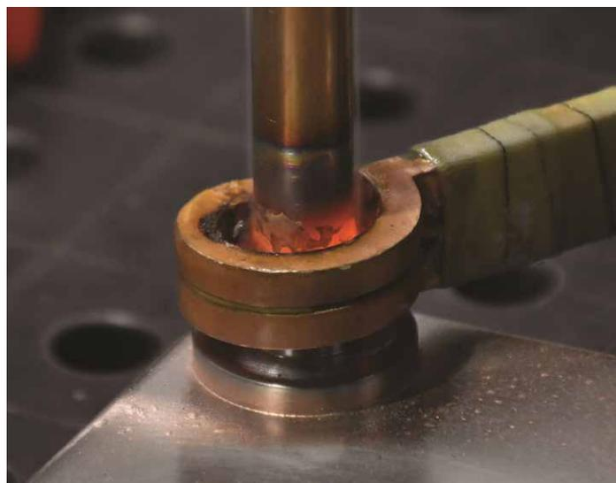
**Bild 2:** Kupferrohr wird durch Ringinduktor und Fülldraht-Lotring in Chromnickelstahl-Stutzen eines Verdampfers eingelötet.
