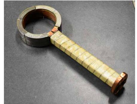
**Bild 14:** Ein Ringinduktor mit Innendurchmesser 65 mm und größerer Breite, beispielsweise zum Löten von 54-mm-Kupferrohr (© VauQuadrat GmbH)
