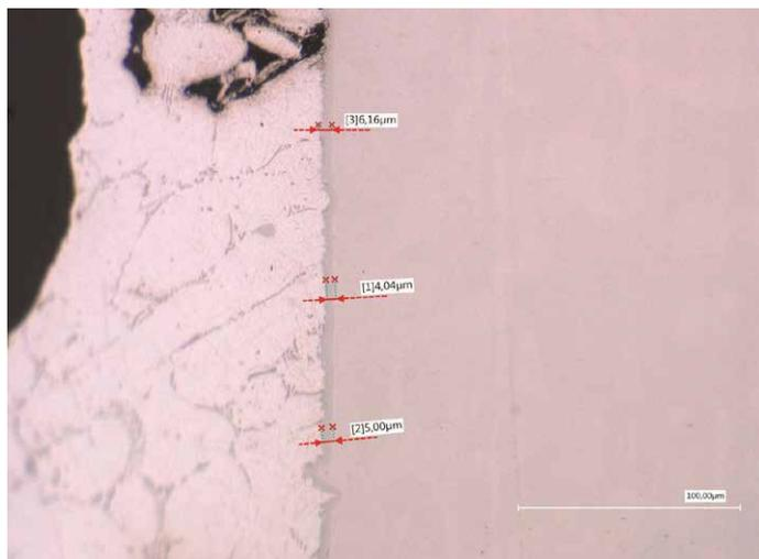
**Bild 17:** Bemaßter Schliff zur Identifikation intermetallischer Phasen
