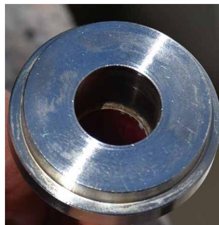
**Bild 7:** So sieht die Fertigungslötung mit Tiefeninduktion routinemäßig, also ganz ohne vorherige Reinigung und „nachlässig handgeführt“ aus – oben (links) wie unten (rechts) komplett kerbfrei. (© VauQuadrat GmbH)
