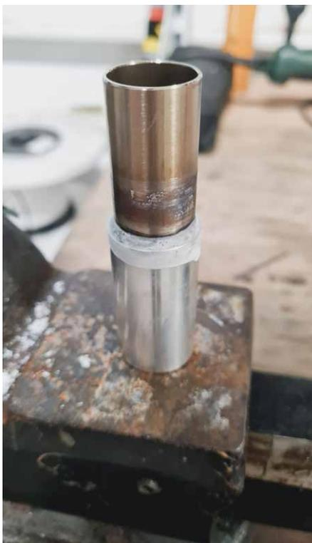
**Bild 15:** Eine Mischverbindung Aluminium-Chromnickelstahl direkt nach dem Löten, ohne Nachbehandlung (© VauQuadrat GmbH)
