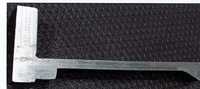
Bild 15: Nach dem Abdrehen der Außenseiten und dem Blick in den Querschnitt zeigt sich die hohe Qualität des entstandenen Schweißguts. Lunker oder Risse sind nicht erkennbar. (© VauQuadrat GmbH)
