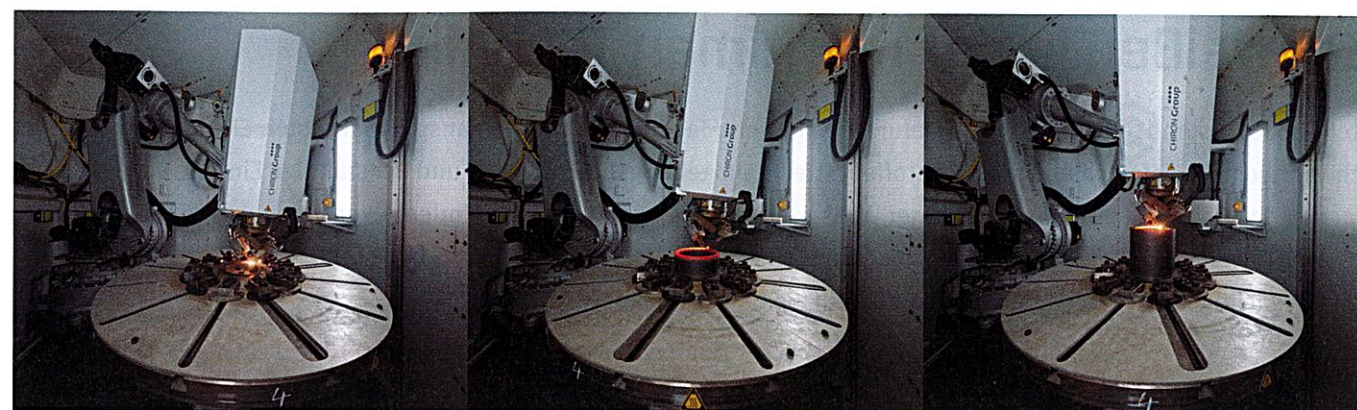
Bild 13: Blick auf den lagenweisen Aufbau der Schweißlagen mittels Laser (© SKF Marine)
