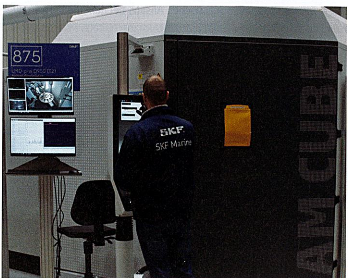
Bild 12: Die Bildschirme links vom Bedienpult visualisieren sämtliche Prozessdaten und überwachen den Innenraum des Cubes sowie den Prozessbereich. (© VauQuadrat GmbH)
