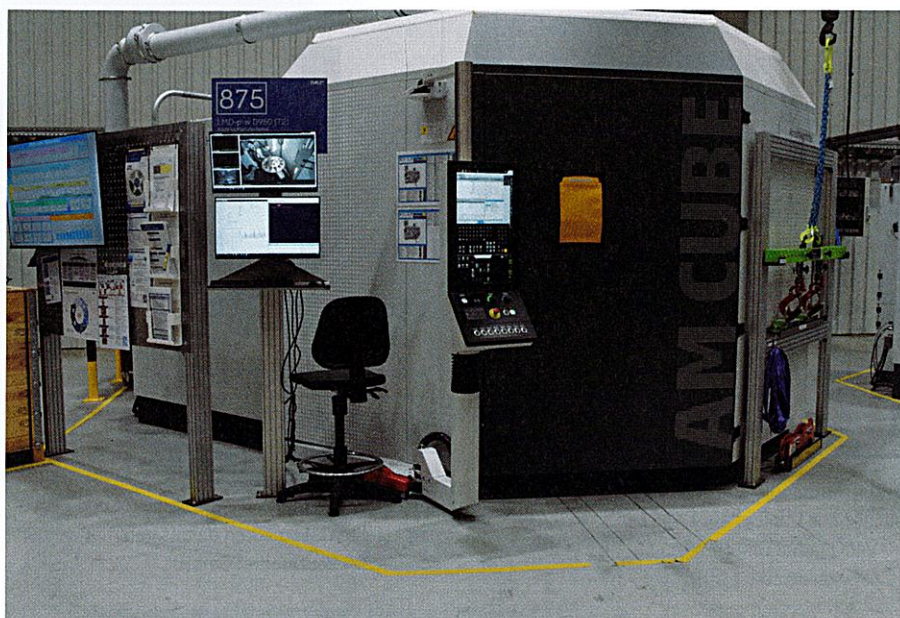
Bild 6: Der „AM Cube“ – die automatisierte Anlage, in der Laufbuchsen-Rohlinge aus Duplexstahl additiv gefertigt werden. (© VauQuadrat GmbH)
